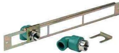
La posición y fijación definitiva se conseguirá, haciendo coincidir los extremos libres de los accesorios con las perforaciones realizadas en el panel. Estas perforaciones se harán a la distancia que corresponda según el artefacto sanitario a conectar (fig. c).
