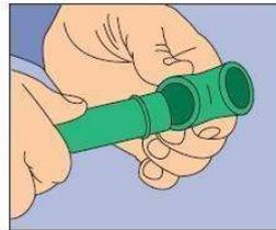
**8-** Cumplida la etapa de calentamiento y retirados tubo y accesorio de sus respectivas boquillas, hembra y macho respectivamente, los dos elementos deben unirse rápidamente introduciendo la punta del tubo en el interior de la pieza hasta que los dos anillos o cordones se junten.
