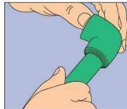
**9-** Cuando los dos anillos o cordones se juntaron el esfuerzo de empuje debe cesar. La unión de los dos cordones evidencia que la penetración del tubo fue la adecuada y que la etapa previa de calentamiento fue cumplida exitosamente. Recordamos que los cordones o anillos se forman por el escumamiento del material del tubo y del accesorio.
