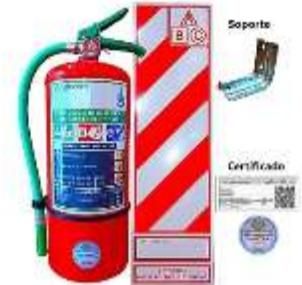
Se deberá proveer e instalar a 1,40 m altura aprox. del suelo, 2 (dos) Extintores Halogenados - HCFC (ABC) x 5,0 kg. (s/ IRAM 3504). Demarcados en planos a adjuntar y/o a indicar por la inspección de obra. Se colocará con chapa baliza indicativa según agente extintor y soporte. Deben tener el sello de la Norma IRAM y garantía de fabricación: 1 (un) año.
