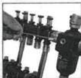
2.- Introducir por la vana un destornillador de 3 mm de Ø máximo, hasta que los imanes se adhieran y rebroten al exterior.
